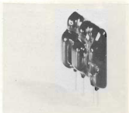
Relé allo stato solido con configurazione di pin-out in linea compatibile con moduli standard AC.
