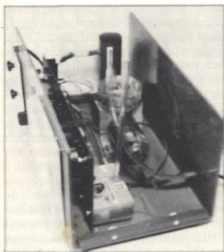
Fig. 3 - Lo strumento contiene anche parecchie parti meccaniche. E' importante che i collegamenti mediante tubetti non vengano scambiati. La parte elettronica è di facile costruzione.
