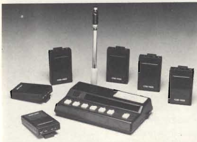
Sistema di comunicazione a distanza il cui raggio d'azione arriva fino a 3 Km di spazio aperto.
